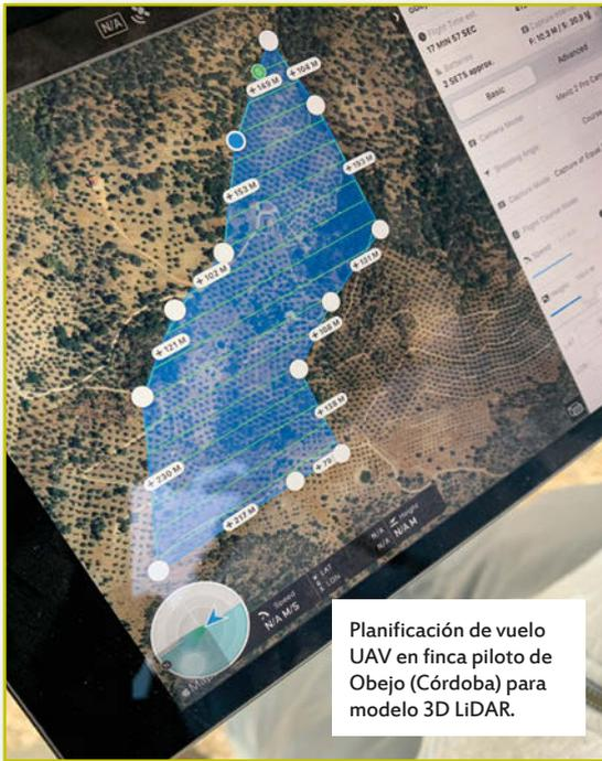
Planificación de vuelo UAV en finca piloto de Obejo (Córdoba) para modelo 3D LiDAR.
